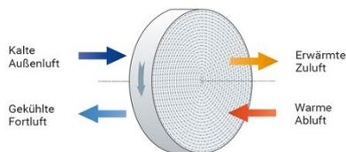
So funktioniert der Rotationswärmetauscher:
